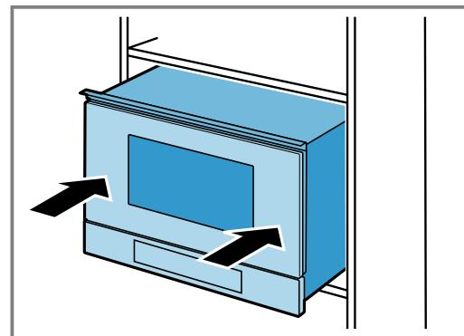
Varmista, että liitääntäjohto ei taitu, jää puristuksiin tai kulje terävien kulmien yli.
