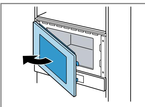
**4. Kiinnitä laite ruuveilla kalusteesseen saranoiden vastakkaisella puolella.**
