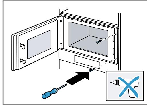
5. Förborra hålen för skruvfästena på stommens gångjärnssida.
