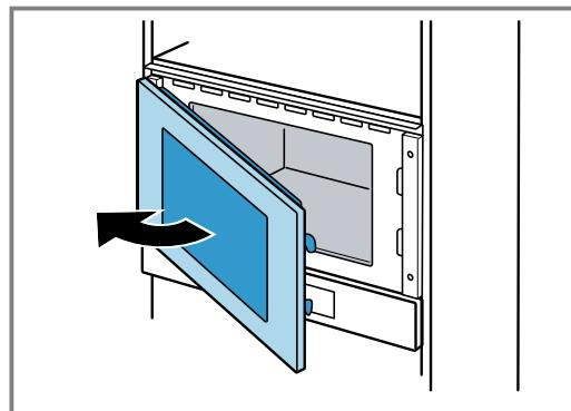
4. Skru apparatet fast til kjøkkenelementet på motsatt side av hengslene.
